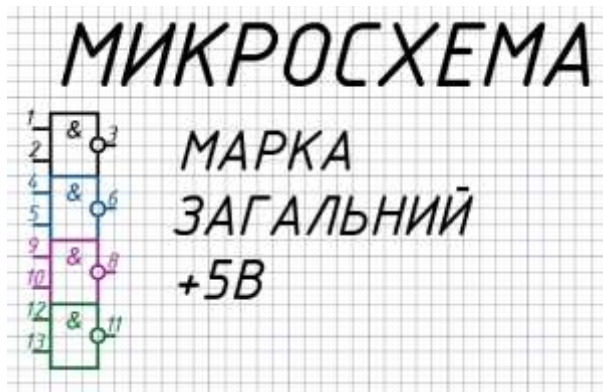
Рис. В.13. Приклад атрибутів для елемента схеми
